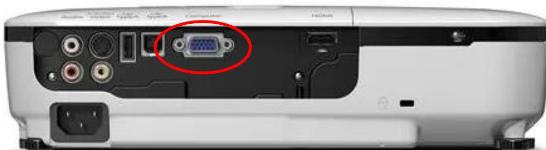
A imagem acima destaca a entrada VGA do equipamento. Nas salas de aula essa conexão já foi feita e a outra ponta para conexão (imagem abaixo) está disponível no canto da sala de aula, parede oposta à porta ou no centro, dependendo da sala de aula.
